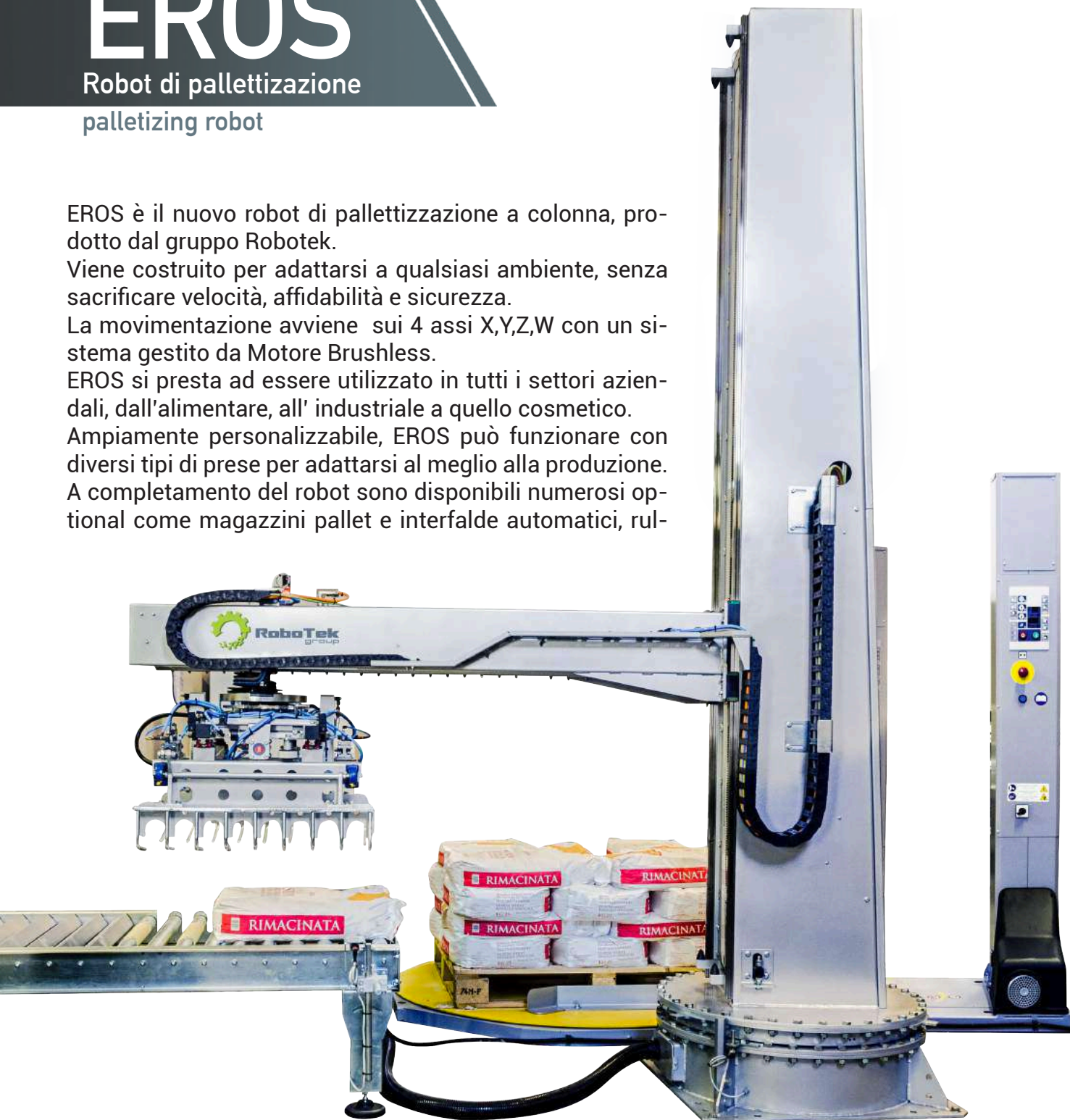
EROS- Robot di pallettizzazione monocolonna con pinza sacchi
